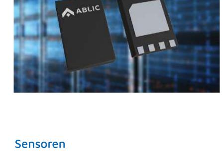
(SPD) EEPROM mit einer Hub-Funktion (SPD5 Hub) und einem integrierten Temperatursensor. Die Hub-Funktion ermöglicht die Isolierung eines lokalen Busses vom Host-Controller-Bus. Der IC
